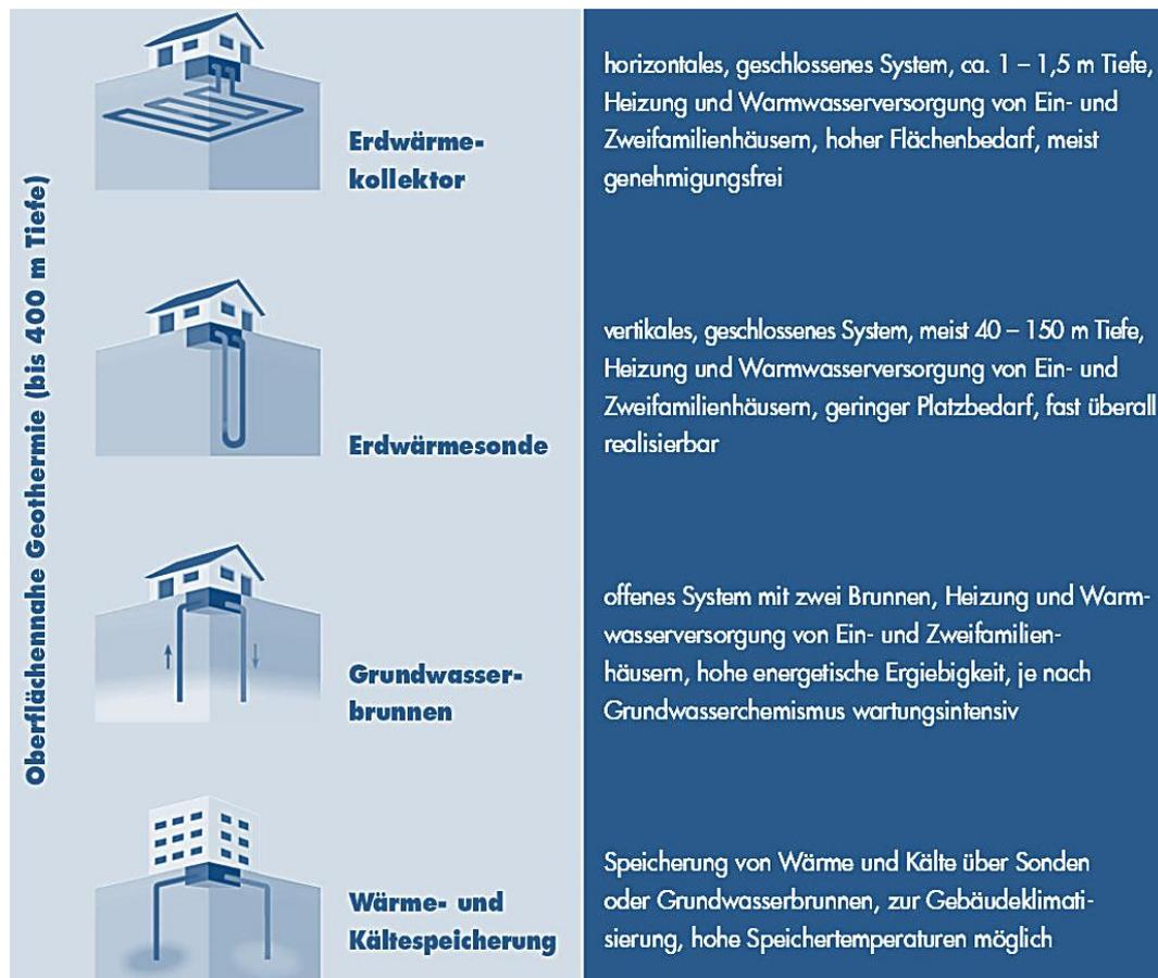
Abbildung 3-7: Nutzungsmöglichkeiten oberflächennaher Geothermie<sup>25</sup>
